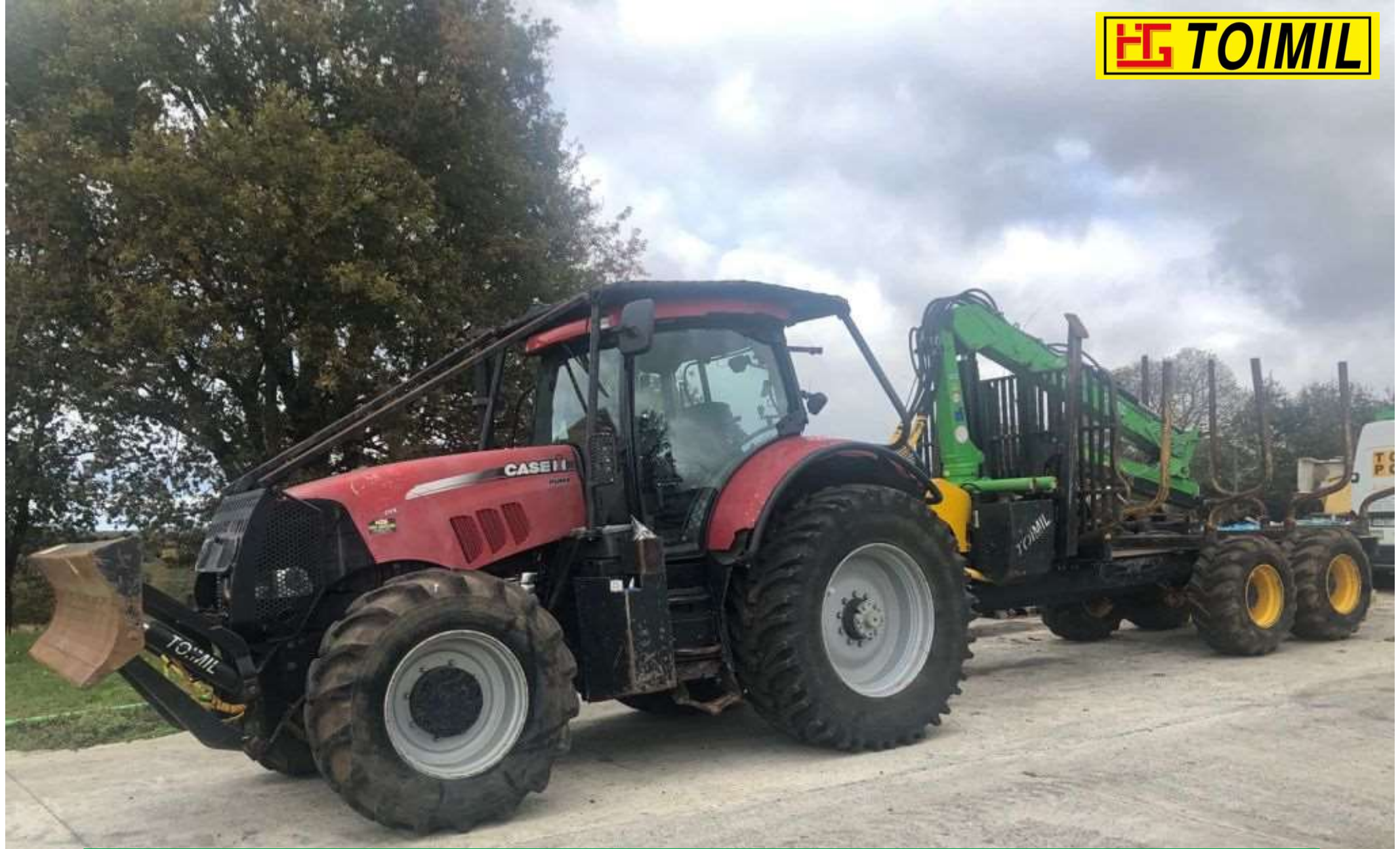
EQUIPO FORESTAL TOIMIL INSTALADO EN PUMA 200
