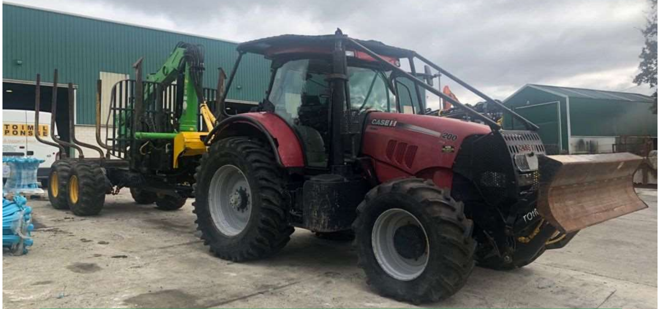
EQUIPO FORESTAL TOIMIL INSTALADO EN PUMA 200
