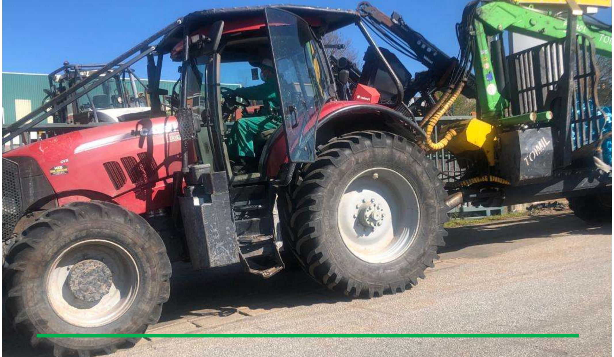
EQUIPO FORESTAL TOIMIL INSTALADO EN PUMA 200
